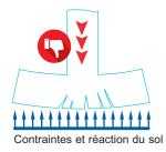
Les cadres trop espacés aux deux extrémités (20 cm ou 15 cm) ne permettant pas le frettage.
